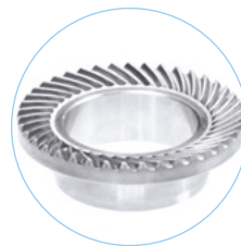
Stirradgetriebe Material: 1.4034 Tiefe: 1,7 mm Prozesszeit: 8 min. Mehrfachbearbeitung: 4-fach Ra: 0,15 µm
