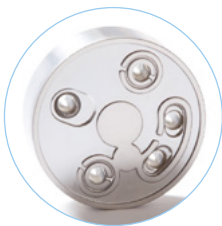
Ventilplatte Material: 1.4034 /1.4112 Tiefe: 1,82 mm Prozesszeit: 448 sek. Mehrfachbearbeitung: 24-fach Ra: 0,07 µm
