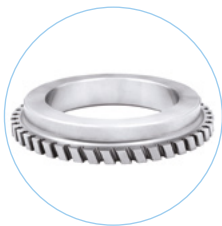
Aveole Material: Inconel 713c Tiefe: 20 mm Prozesszeit: 45 min. Ra: 0,8 µm
